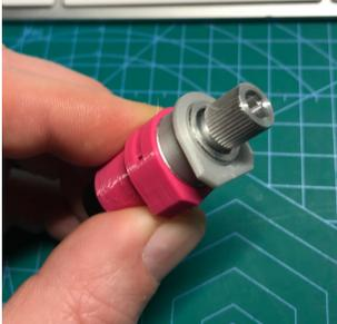
Danach den Adapter auf der entgegengesetzten Seite aufsetzen. Je nach Messertyp der verwendet wird kann es schon möglich sein, dass das Aufsetzen schwergängig ist.
