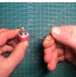
Zu guter Letzt die Madenschraube mit dem mitgelieferten Innensechskant anziehen. Bitte die Madenschraube wie abgebildet mit der langen Seite des Innensechskantschlüssels verwenden.
